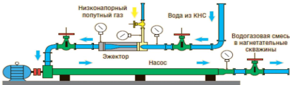
Рис. 3. Технологическая схема станции для водогазового воздействия в пласт.
