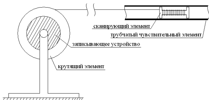
Рис. 2. Принципиальная схема сканирующего устройства.
