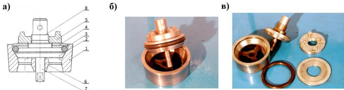
а) схема клапана: 1 – седло; 2 – тарель; 3 – уплотнительное кольцо; 4 – прижимная втулка; 5 – упорная гайка; 6 – крестовина; 7 – хвостовик; 8 – ограничитель подъема; б) в сборе; в) в разборе
