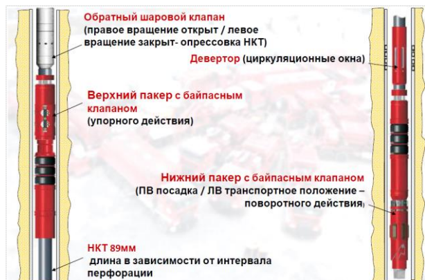
Рис. 1. Схема компоновки пакера ПС-168С.
