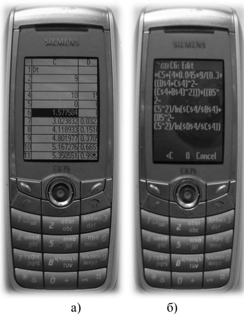
Рис. 1. а) модель составленная на сотовом телефоне б) вид формулы моделирования в ячейке С6.
