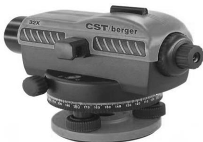
Рис. 3. Внешний вид оптического нивелира CST/Berger SAL 32 ND.
