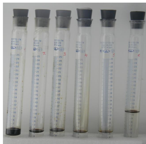
Рис. 3. Установка многофазной фильтрации через керн ТВР-604 Coretest Systems и отобранные 7 поровых объемов жидкости после вытеснения нефти раствором ТНХС-14.0.
