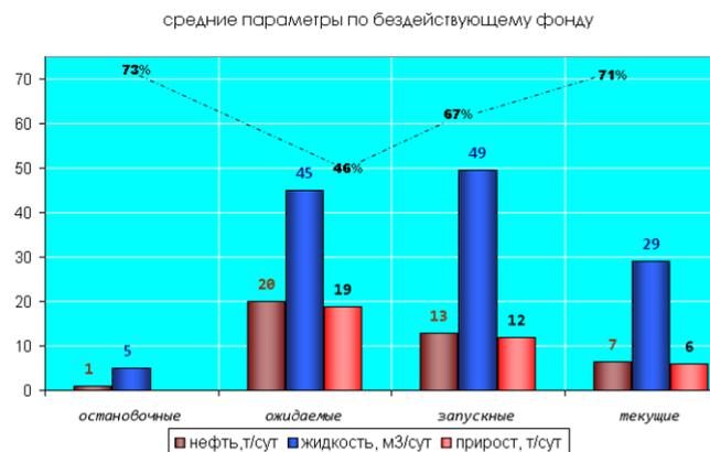
Рис. 1. Динамика параметров скважин в результате проведения ГРП на бездействующем фонде скважин
