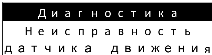
Рисунок 5.3.1.11 – Сообщение о неисправности датчика движения
