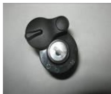
**Рисунок 8 – Замок зажигания**
