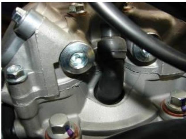
Рисунок 27 - Колпачок свечи зажигания
