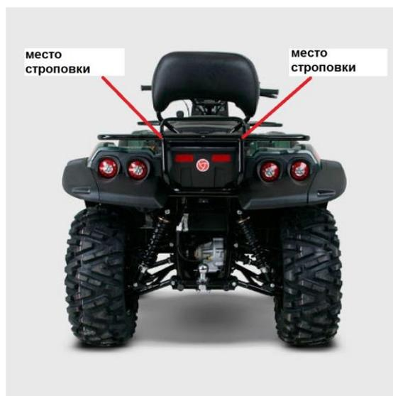
Рисунок 33 – Места строповки
