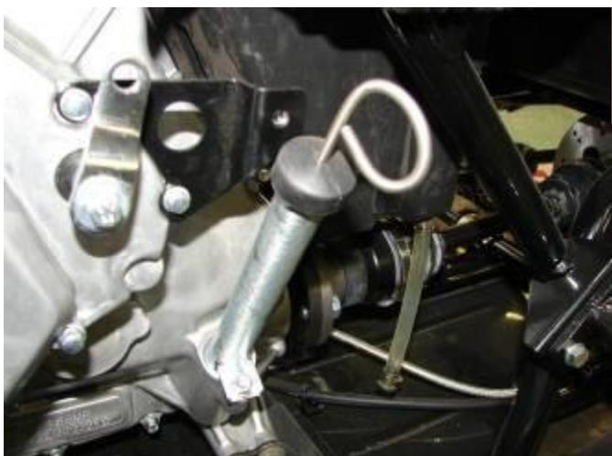
Рисунок 17 - Расположение масляного щупа на двигателе
