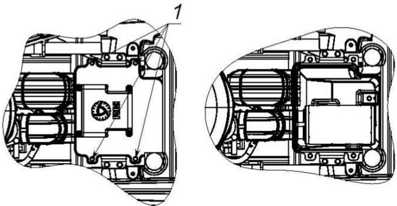
1 - Болты крепления крышки воздушного фильтра
