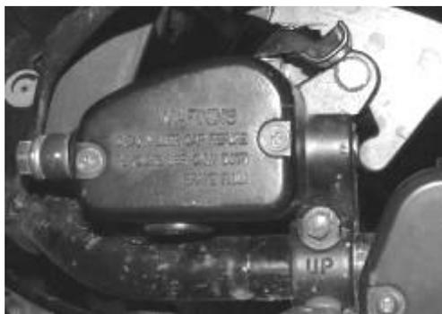
Рисунок 26 - Крышка главного тормозного цилиндра
