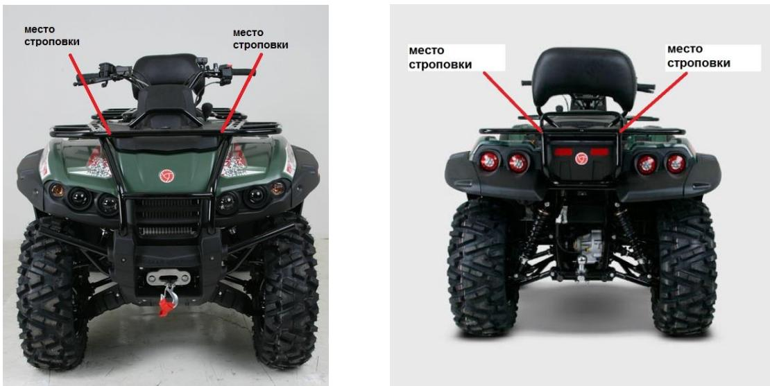
Рисунок 33 – Места строповки
