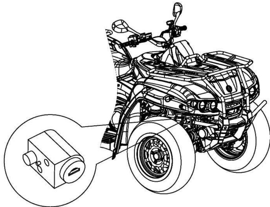
Рисунок 9 – Блокировка рулевого управления
