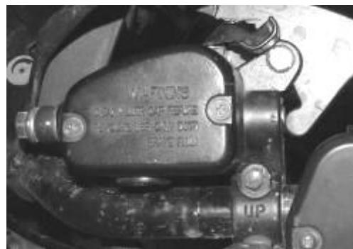
Рисунок 26 - Крышка главного тормозного цилиндра
