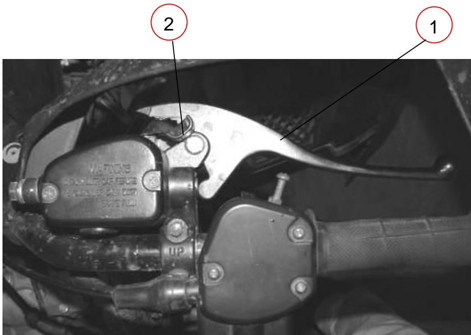
1 – Тормозной цилиндр; 2 – Фиксатор
