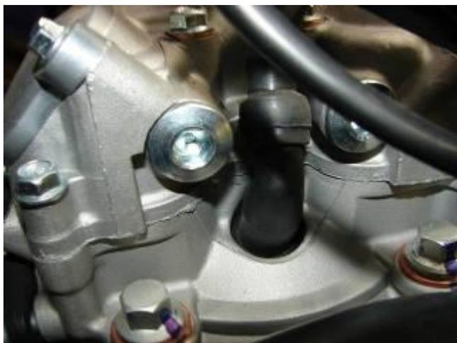
Рисунок 27 - Колпачок свечи зажигания
