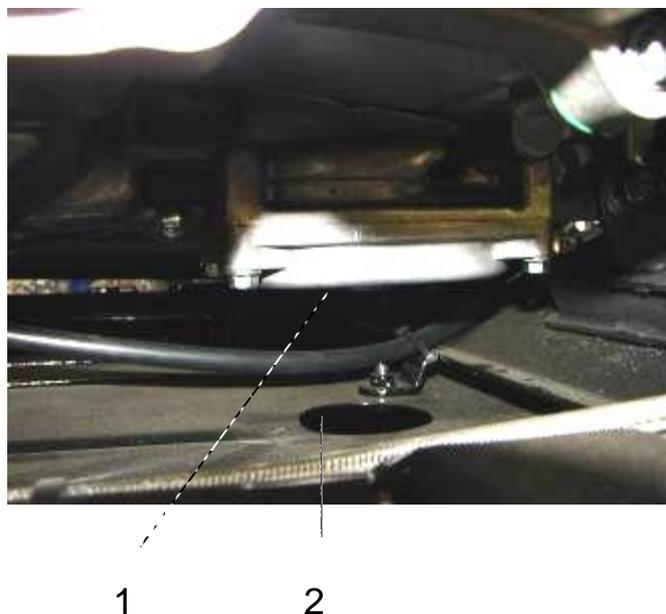
1- пробка сливного отверстия, 2- отверстие в защите двигателя
