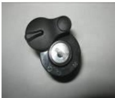
Рисунок 8 – Замок зажигания
