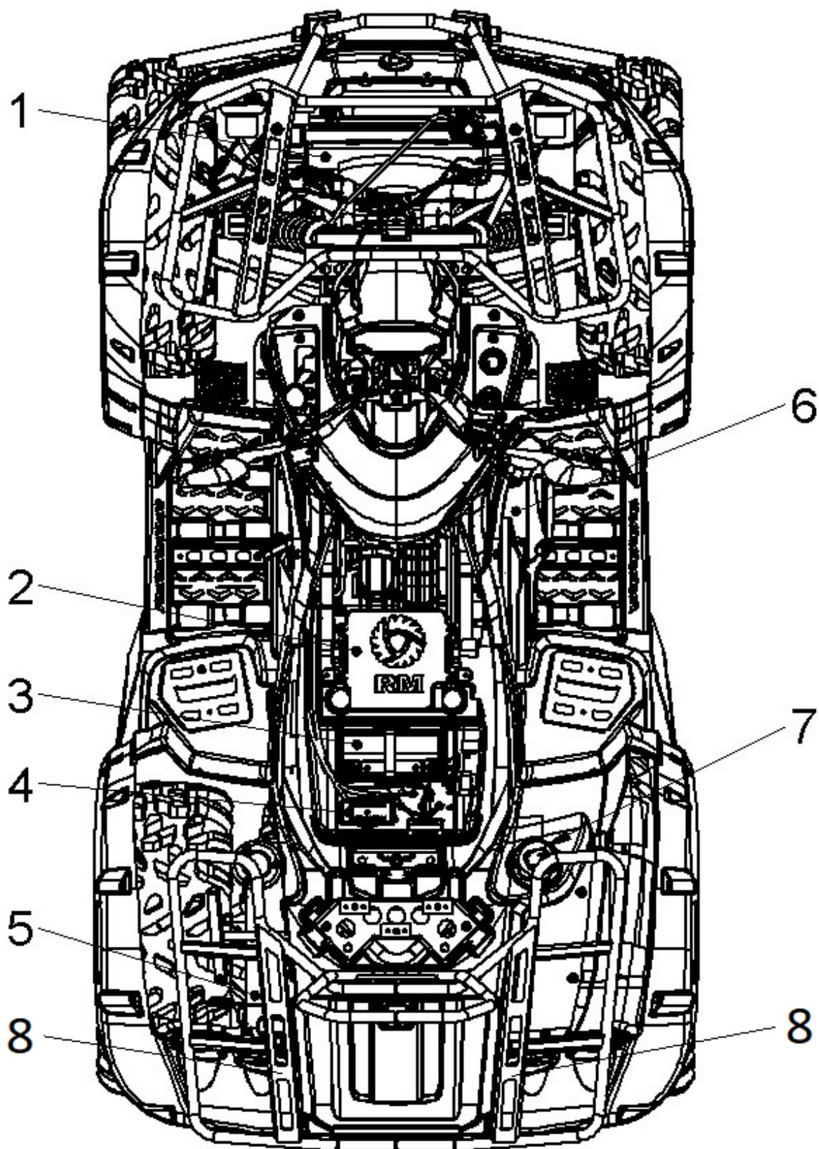
1 – Система охлаждения; 2 – Система впуска; 3 – Аккумулятор;
