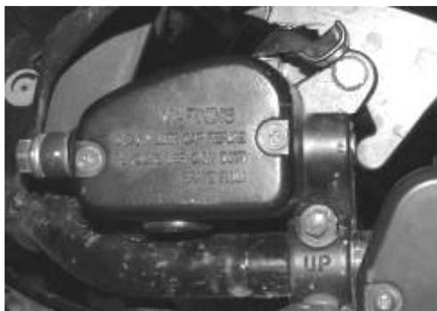
Рисунок 26 - Крышка главного тормозного цилиндра
