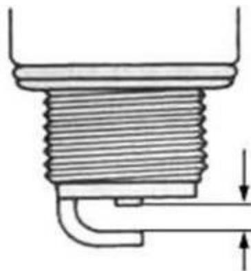
Рисунок 28 - Зазор между электродами свечи зажигания
