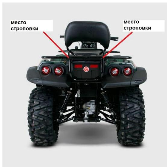
Рисунок 33 – Места строповки
