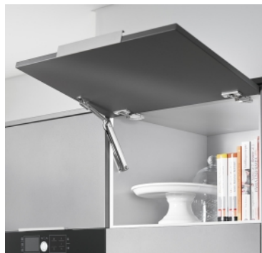
AVENTOS HK-XS Поворотный подъемник для малых верхних шкафов Высота корпуса 240-600 мм Внутренняя глубина от 125 мм Возможна установка TIP-ON
