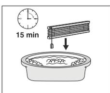
3. Погрузить изделие в воду на 15 мин. Изделие допускается погружать в воду полностью (кроме изделий с электроприводом). При чистке изделий с электроприводом избегать попадания воды в карнизы.
