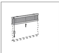
1. Собрать штору и снять ее с кронштейнов. Для этого допускается использовать отвертку.
