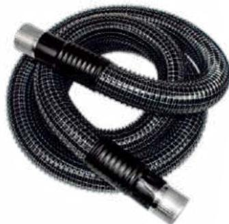
2. Гибкий электропроводный, антидеформационный шланг, изготовленный из EVA (этиленвинилацетат), с антистатической функцией, в соответствии со стандартом DIN 53482, электрическое сопротивление поверхности <math><10^6</math> Ом.
