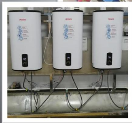
Изделия изготавливаются на специализированных предприятиях с богатым опытом производства водонагревательного оборудования. Перед тем, как попасть к покупателю, водонагреватели проходят тестирование на герметичность, максимальное давление и безопасность.
