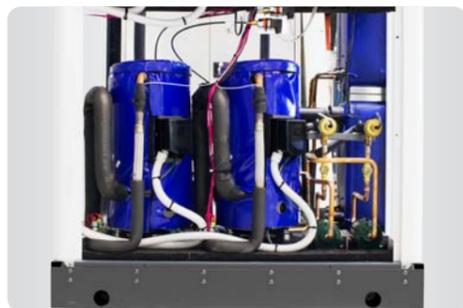
В линейке XSW используется решение multiscroll с несколькими спиральными компрессорами установленными на одном контуре, ТРВ с электронным управлением, компактные пластинчатые теплообменники и возможность управлять циркуляционными насосами внешнего гидромодуля посредством встроенного ПО - все это позволяет достигать максимальной энергоэффективности, особенно при частичной нагрузке.
