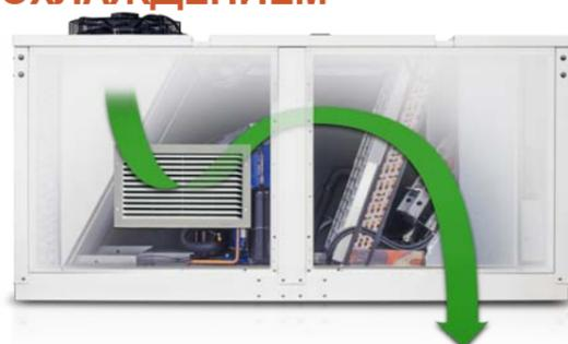
Опционально агрегаты гаммы **HTR** могут быть оснащены модулем прямого естественного охлаждения. Система может работать в режиме частичного естественного охлаждения, что позволяет повысить энергосбережение, поскольку уменьшает количество часов работы компрессора. В этом случае необходима заслонка избыточного давления.
