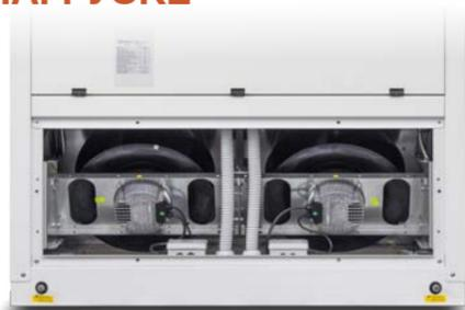
Использование ЕС-вентиляторов (в стандартной комплектации) в испарительной секции позволяет сократить до минимума эксплуатационные расходы, что способствует увеличению энергоэффективности агрегата, особенно при частичной нагрузке. Для достижения максимального энергосбережения доступна также версия с компрессорами BLDC с частотным регулированием.
