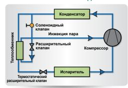
В спиральных компрессорах гаммы **HPS** используется технология инжекции пара: небольшая часть хладагента в виде пара под средним давлением «впрыскивается» в камеру сжатия компрессора. Эта система позволяет повышать как мощность охлаждения (соответственно мощность нагрева), так и эффективность и, прежде всего, расширение рабочего диапазона теплового насоса, что делает гамму **HPS** идеальным решением для регионов с холодным климатом.
