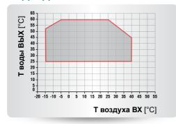
Агрегаты гаммы **HPS** могут производить воду температурой 65°C, а также работать при наружной температуре до -20°C.
