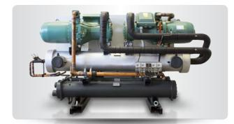
Винтовой компрессор обеспечивает высокую холодопроизводительность с возможностью изменения нагрузки посредством специального золотникового клапана. По запросу доступно исполнение с плавным регулированием, с инвертором на обоих компрессорах или только на одном компрессоре для более тонкой регулировки мощности охлаждения, что обеспечивает очевидные энергетические преимущества.
