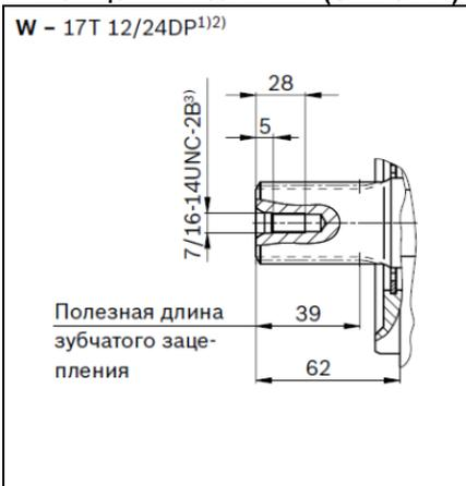
**▼ Цилиндрический вал с призматической шпонкой (DIN 6885)**
