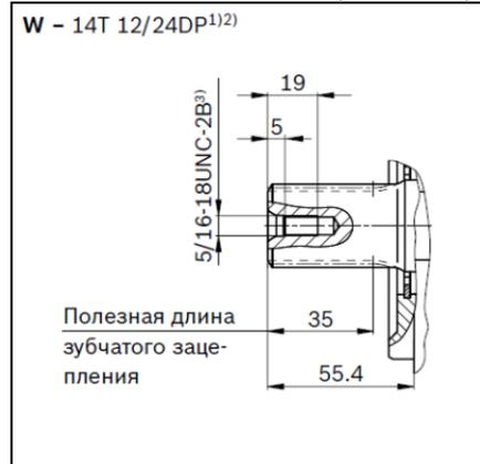
**▼ Цилиндрический вал с призматической шпонкой (DIN 6885)**
