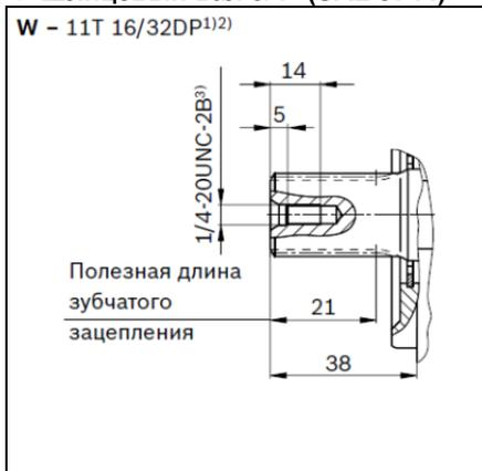
▼ Цилиндрический вал с призматической шпонкой (DIN 6885)
