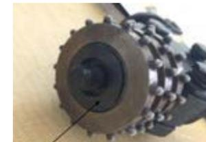
5. Установите тарельчатую пружину на вал со стороны внешней крышки подшипника.
