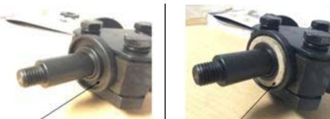
2. Установите режущий механизм на вал до упора в поддерживающую пластину.
