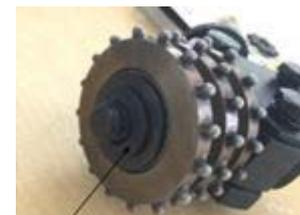
6. Установите на вал шестигранную гайку. Затяните таким образом, чтобы гайка была затянута достаточно туго, но при этом режущие механизмы могли свободно вращаться на подшипниках (если не вращаются, значит гайка перетянута).
