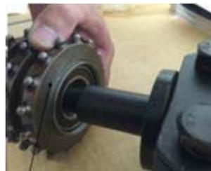
3. Установите войлочную шайбу на вал в пространстве между краем режущего механизма и краем подшипника.
