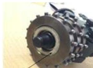
4. Установите внешнюю крышку подшипника на вал со стороны войлочной шайбы.
