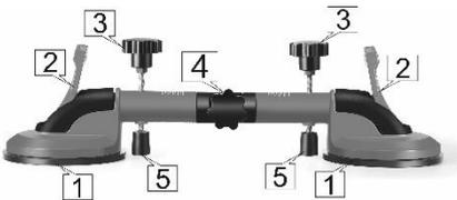
Фиксация угла раскрытия осуществляется винтом №4. Установите рабочие поверхности присоски №1 на поверхности прилегающих друг к другу плиток. Опустите фиксаторы №2 на каждой стороне для крепления присосок на поверхностях плиток. Вытягивание плиток с помощью регулировочных винтов №3.
