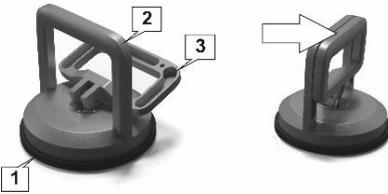
Установите рабочую поверхность присоски №1 на поверхность и надавите на вертикальную часть №2. Соедините подвижную часть рукоятки №3 с вертикальной частью №2. Для демонтажа – отклоните ручку №2.
