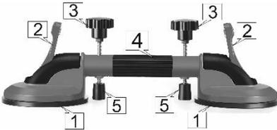
Установите рабочие поверхности присоски №1 на поверхности прилегающих друг к другу плиток. Надавите на рукоятку №4. Опустите фиксаторы №2 на каждой стороне для крепления присосок на поверхностях плиток. Регулировка шва между плитками осуществляется поворотом рукоятки №4. Выравнивание высоты плиток с помощью регулировочных винтов №3.
