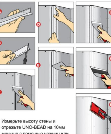
Измерьте высоту стены и отрежьте UNO-BEAD на 10мм меньше с помощью ножниц или ножа.
