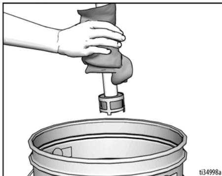
4. Поместите всасывающий патрубок в соответствующую промывочную жидкость. Поместите сливную трубку в ведро для отходов.
