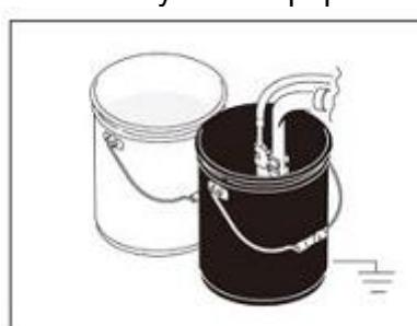
10. Погрузите сифонную трубку в заземленное металлическое ведро с жидкостью. Нажмите на спусковой механизм, чтобы смыть масло из распылителя. Используйте уайт-спирит, чтобы удалить краску на водной основе, масляную краску и консервационную смазку.
