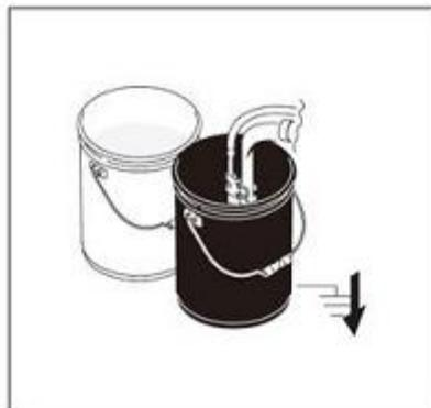
5 Выньте трубку сифона из краски и поместите ее в промывочную жидкость. Используйте воду для очистки от краски на водной основе и уайт-спирит для очистки от масляной краски
