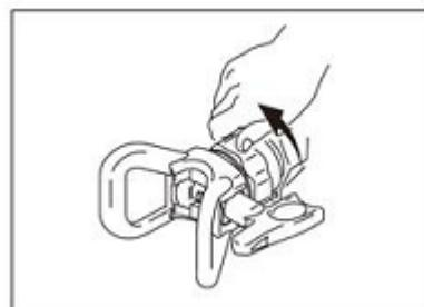
4. Снимите предохранитель наконечника
