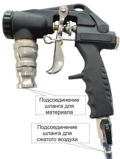
**Внимание!** При подаче материала (шпатлевки, штукатурки и т.п.) в пистолет, не нажимайте на курок, при закрытом кране подачи сжатого воздуха от компрессора. Или при отсутствии давления сжатого воздуха от компрессора.
