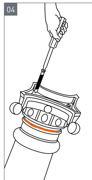
**4** Соедините капитель и ствол колонны между собой дополнительно скрепив саморезами.
