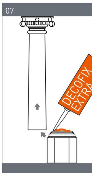
**7** Установите изделие в заранее размеченном месте. Нанесите специальный клей для стыков «Decofix Extra» на верхнюю часть основания (базы) колонны и приставьте ее для окончательного соединения всех элементов.
