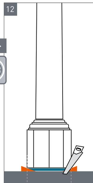
**12** После полного высыхания клея (24 часа) обрежьте выступающие части клиньев с помощью ножовки.
