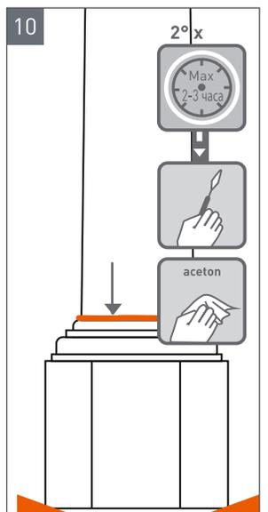
**10** Удалите излишки клея со стыка, затем протрите ацетоном.
