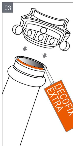
**3** Нанесите специальный клей для стыков «Decofix Extra» на торцевую поверхность изделия с избытком, заполняя всю плоскость стыка.
