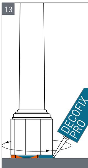
**13** Прошпаклюйте изделие в местах всех соединений. После полного высыхания шпаклевки зашкурьте места соединений мелкозернистой шкуркой.
