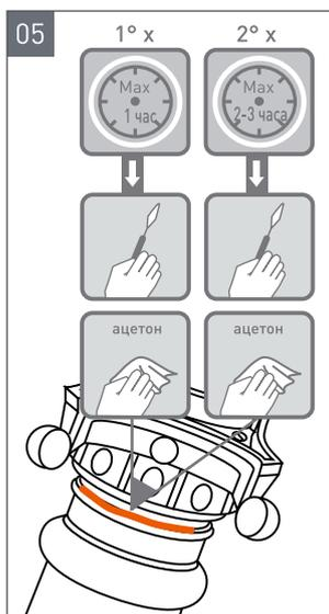
**5** Удалите излишки клея со стыка, затем протрите ацетоном.
