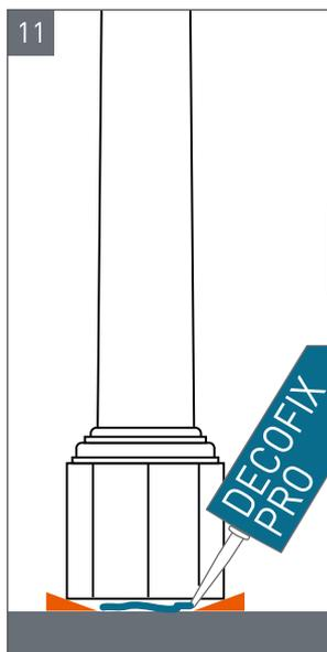
**11** Заполните пустоты между полом и основанием (базой) колонны монтажным клеем «Decofix Pro».
