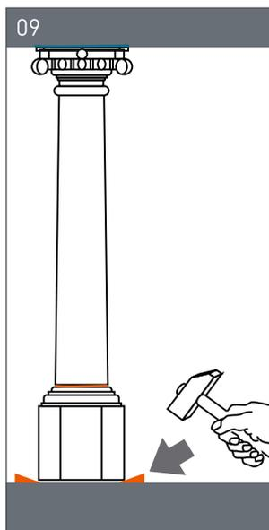
**9** Зафиксируйте по кругу колонну в распор с помощью клиньев.
