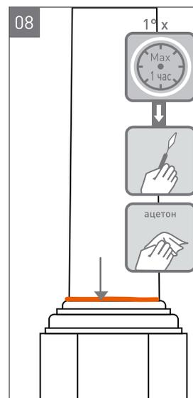
**8** Удалите излишки клея со стыка, затем протрите ацетоном.
