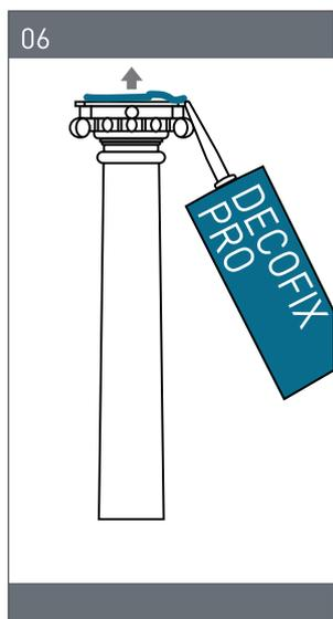
**6** Равномерно нанесите монтажный клей «Decofix Pro» на верхнюю часть изделия примыкающую к потолку.
