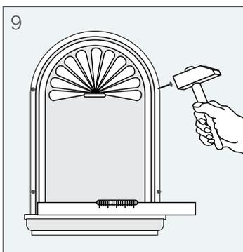
**6** Закрепите изделие при помощи саморезов. Саморезы необходимо вкрутить, утопив их в само изделие, а затем зашпатлевать отверстия.
