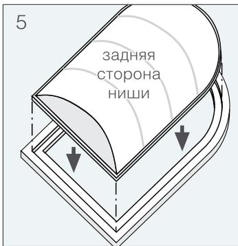
**4** Соедините и зафиксируйте нишу с декоративным элементом (рамкой) между собой при помощи саморезов по кругу.
