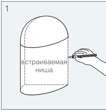
**1** Сделайте разметку под отверстие по размеру ниши, в том месте, где планируется установка изделия.
