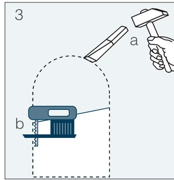
**2** При необходимости вырежьте отверстие с помощью лобзика или ножовки.
