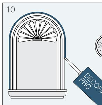
**7** Равномерно нанесите монтажный клей «Decofix Pro» по всему периметру декоративного элемента. Снимите излишки клея с помощью шпателя.
