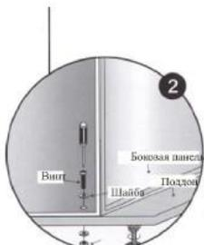
Поместите стенку кабины на нижнем поддоне (убедитесь в том, что стена стоит перпендикулярно к нижнему поддону). Используйте 4 болта с плоскоконической головкой М5х35, шайбы диаметром 5 и 5 гаек М5 для того, чтобы временно закрепить стенку кабины на нижнем поддоне (не закручивайте плотно, чтобы можно было отрегулировать положение; более плотно вы сможете закрутить гайки на более позднем этапе установки).
