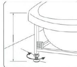
если пол неровный выровнять поддон с помощью регулировочных болтов
