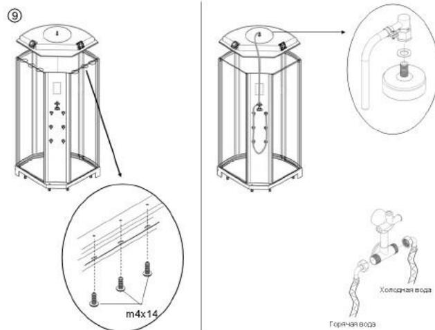
Схема сборки асимметричной душевой кабины.
