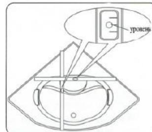
Установите поддон в нужное положение. Используйте уровень, чтобы выровнять положение поддона. (Этот шаг очень важен). Если не выровнять положение поддона, душевая кабина будет установлена криво и не будет устойчива, соответственно резьбовые отверстия (отверстия под винты) не будут находиться на одной линии друг с другом. Если поддон стоит неровно, отрегулируйте его положение с помощью нижних болтов с резиновыми наконечниками. Затем заблокируйте контргайкой.
