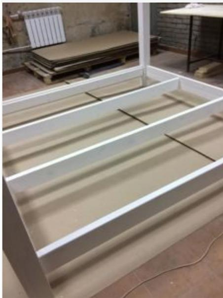
10. Установить последовательно (2 шт) крестовину поз.12 между досками фасадными верхними поз.4 и 5, и через отверстия в доске фасадной и торцах крестовин стянуть еврошурупами (конфимантами) поз.14 в количестве по 2 шт. при помощи ключа шестигранного поз. 18 как на Фото 8.
