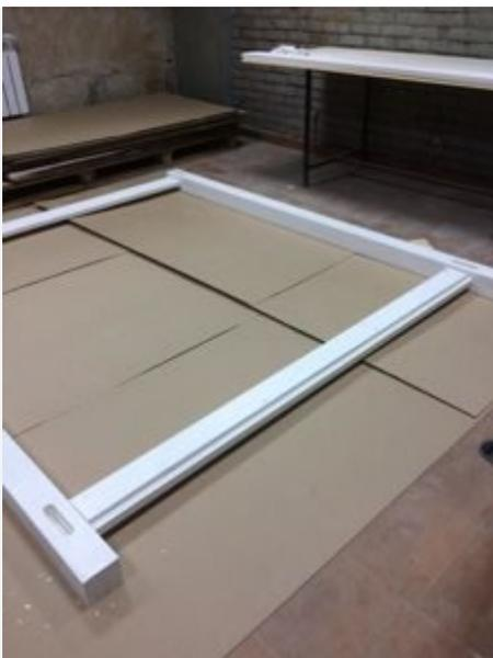
3. Вставить в отверстия опоры 1. шурупы и при помощи крестовой отвертки (в поставку не входит) затянуть шурупы 5x80 мм поз.16 в количестве по 2 шт , что бы закрепить доску в опоре. В верхние фасадные доски через отверстия в опоре поз.1 вворачиваются еврошурупы (конфиманты) поз.14 в количестве по 2 шт. при помощи ключа шестигранного поз. 18. как показано на Фото 3
