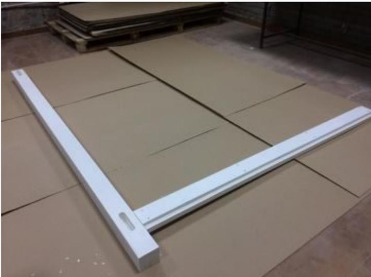
2. Расположить на поверхности опор поперечно нижнюю фасадную доску поз.3 и верхнюю фасадную доску поз.5. Вставить при помощи продольного усилия рук доску нижнюю фасадную поз.3 и доску верхнюю фасадную поз.5 в пазы опор поз.1 согласно схемы и Фото.1. и Фото 2. Предварительно промазать тонким слоем силиконовой смазки стенки пазов на опоре и шпунтов на фасадной доске.
