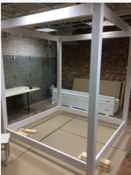
8. Вставить в отверстия опоры 1. шурупы и при помощи крестовой отвертки (в поставку не входит) затянуть шурупы 5x80 мм поз.16 в количестве по 2 шт , что бы закрепить доску в опоре. В верхние фасадные доски через отверстия в опоре поз.1 вворачиваются еврошурупы (конфиманты) поз.14 в количестве по 2 шт. при помощи ключа шестигранного поз. 18.
