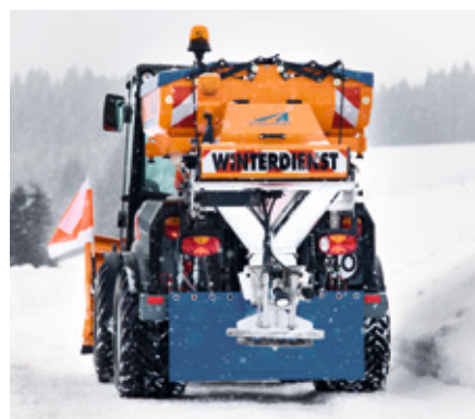
MIC 84 с навесным разбрасывателем
