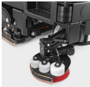
Боковой поломоечный агрегат Обеспечивает влажную уборку вплотную к стенам. При соприкосновении со стеной или иным препятствием агрегат автоматически убирается под машину.
