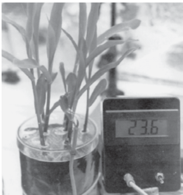
Рис. 11.3. Термистор (терморезистор) в действии.
