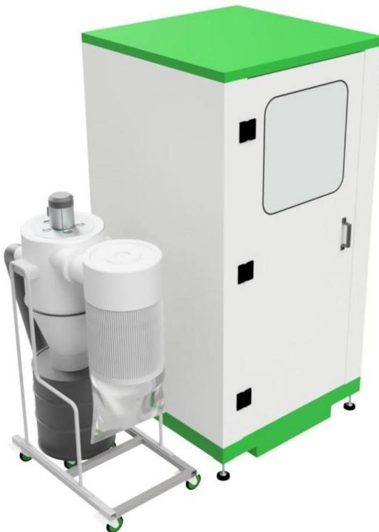
КО состоит из рабочей камеры оборудованной системой удаления пыли с одежды персонала. Стены рабочей камеры и основные узлы – сталь, полимерное покрытие. Крыша кабины перфорирована для поступления свежего воздуха в зону обработки. КО оснащена дверью с механическим доводчиком и прозрачным окном из ударопрочного монолитного поликарбоната.
