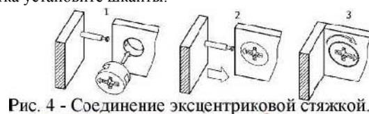
Рис. 4 - Соединение эксцентриковой стяжкой.
