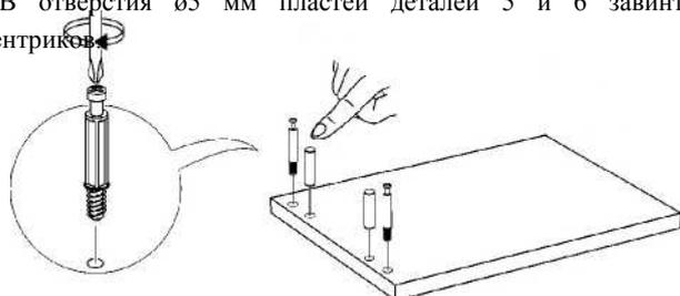
Рис. 3 - Установка шкантов и штоков эксцентриков.
