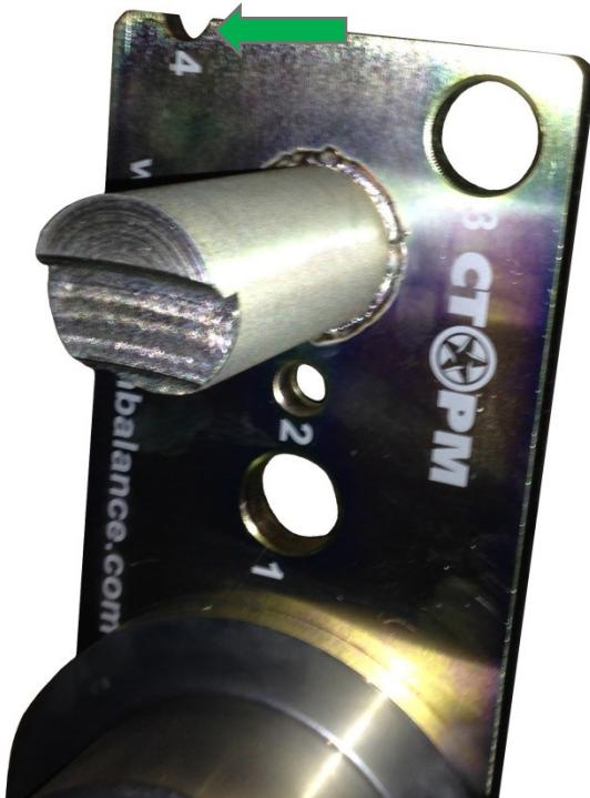
**Внимание:** ручка дистанции в отверстии тест-ротора имеет небольшой люфт и для корректной калибровки потяните ручку дистанции вверх с небольшим усилием.
