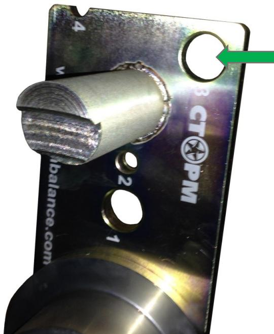
**Внимание:** ручка дистанции в отверстии тест-ротора имеет небольшой люфт и для корректной калибровки потяните ручку дистанции вверх с небольшим усилием.
