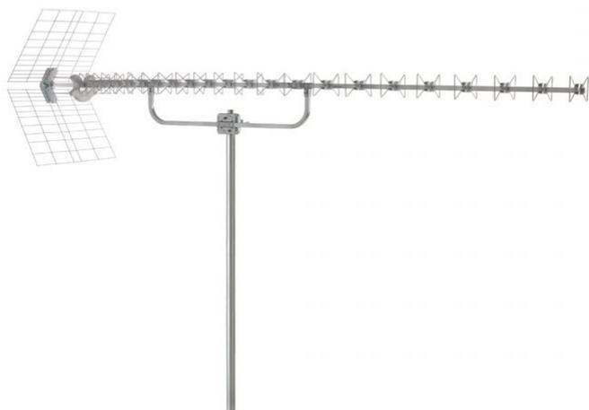
Antenna **biconica** di **banda UHF** con connettore F e riflettore a griglia. Direttori premontati, radiatore e riflettori ad innesto rapido e attacco al palo con regolazione zenitale di serie con **dado a farfalla** per completare il montaggio **senza l'ausilio di alcun utensile**.
