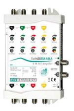
Amplificatori in cascata, 4 ingressi A.B.L.A. con regolazione del guadagno e della pendenza Satellite.
