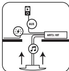
Соедините устройство ART 3.1 с динамиками, а к AUX разъему подключите внешний источник. Подключите систему к сети.
