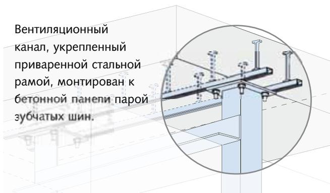
Вентиляционный канал, укрепленный легковесными болтами к панели, монтируется зубчатой шиной.
