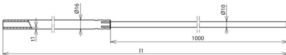
Трубчатый молниеприемник с уменьшением диаметра (1000 мм), облегченный, для защиты надстроек на крыше, труб и т.п. Специально предназначены для установки на бетонном цоколе (17 кг) с клиновым креплением или для установки с помощью дистанционных держателей.
