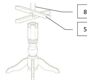
3. Поставить столешницу (поз. 1) на подстольные планки (поз. 5) так, чтобы она стояла ровно относительно всех 4-х сторон. Вкрутить саморезы (поз 8), как показано на рисунке.
