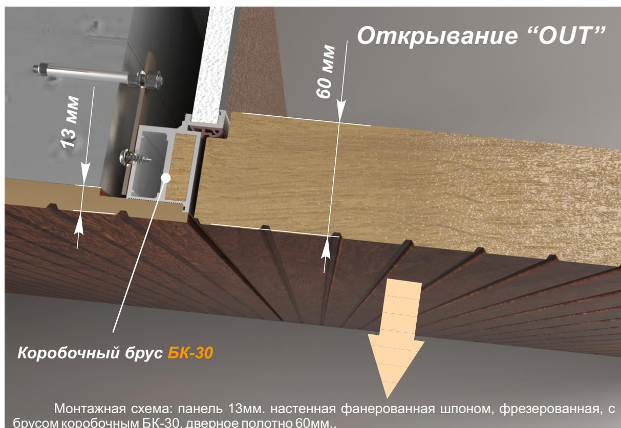
Монтажная схема: панель 13мм. настенная фанерованная шпоном, фрезерованная, с брусом коробочным БК-30, дверное полотно 60мм..
