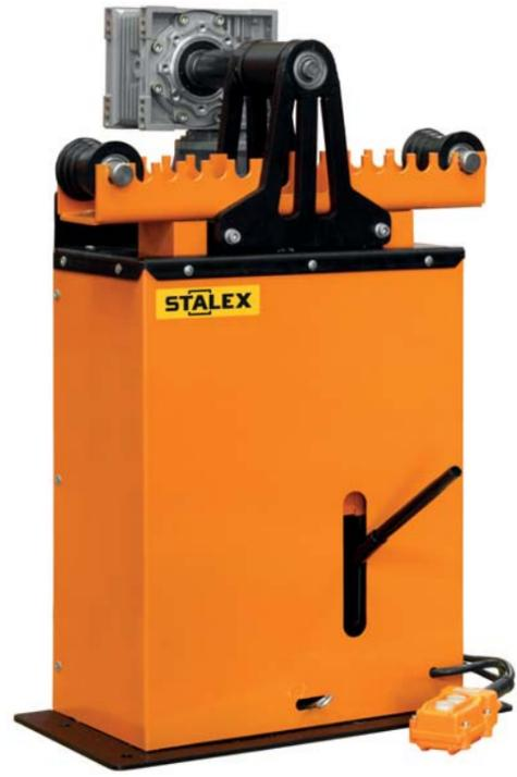
**Станок профилегибочный электромеханический**
