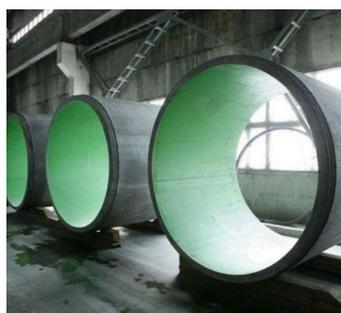
БЕТОННЫЕ ТРУБЫ, ФУТЕРОВАННЫЕ ПОЛИМЕРНЫМ ЛИСТОМ
