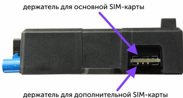
Рис. 3.2. Расположение основной и дополнительной SIM-карты.
