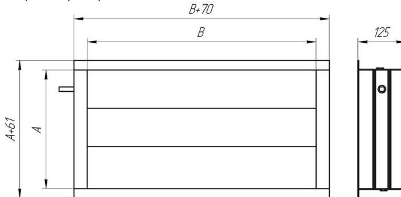
Внутреннее сечение клапана:  $A \times B$ , мм.
